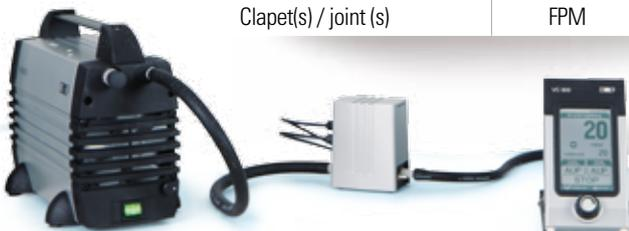
La pompe N920G couplée au régulateur de vide VC900 permet de réguler le vide par variation de vitesse de rotation du moteur.
