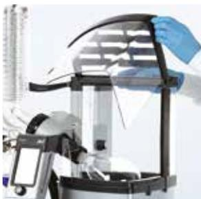
Pour une plus grande sécurité, les RC900 & RC600 peuvent être équipés d'un écran de protection. Ce capot de protection est pivotant, dégageant ainsi l'accès au ballon.
