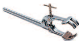
Pince pour la fixation des ballons pour réfrigérants. Référence 47 000 403
