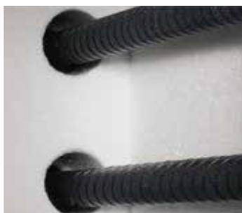
Chambre du four avec matériau fibreux de grande qualité et barres chauffantes SiC des deux côtés
