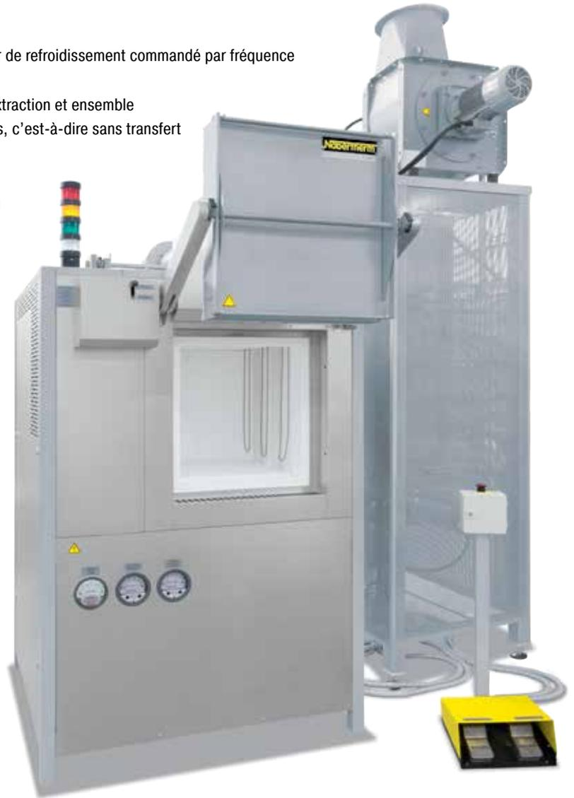
Four haute température HT 160/18 DB200 avec porte guillotine parallèle pneumatique
