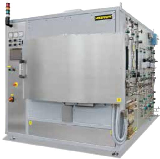
Four moufle étanche NRA 300/09 H<sub>2</sub> pour le traitement thermique avec hydrogène
