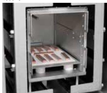
Traitement thermique de barres de cuivre sous hydrogène dans four moufle étanche VHT 8/16-MO
