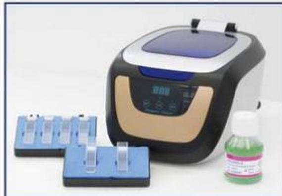
Le bain à ultrasons **CE-5700A**, qui est équipé d'une cuve en acier inoxydable, d'un écran numérique et d'un panneau de commande tactile, est conçu pour nettoyer le petit matériel de laboratoire tels que :
